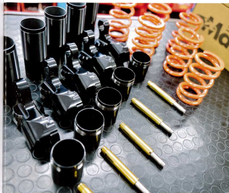
Qui sopra, le parti che compongono il monoammortizzatore Matris M46K. Nella pagina a fianco, il modello M40KC per moto classic/custom e la forcella F43SP, con steli rovesciati di 43 mm Ø.
