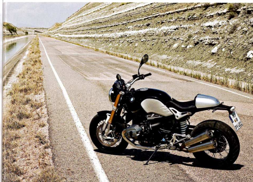
La BMW R NineT del 2014, bella e divertente da guidare, aveva una forcella senza alcun registro. Per far lavorare la sospensione al meglio, la Matris ha realizzato un kit cartuccia con regolazioni.
